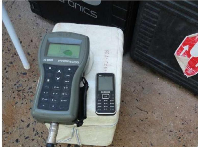
**Foto 5.1** Equipamento de medição *in situ* dos parâmetros físico-químicos
