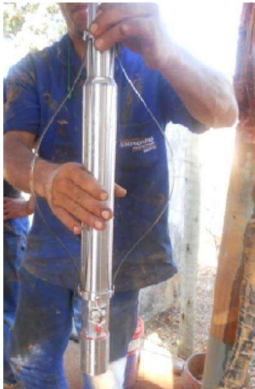
**Foto 4.7** Sensor ótico responsável pela captação das imagens.
