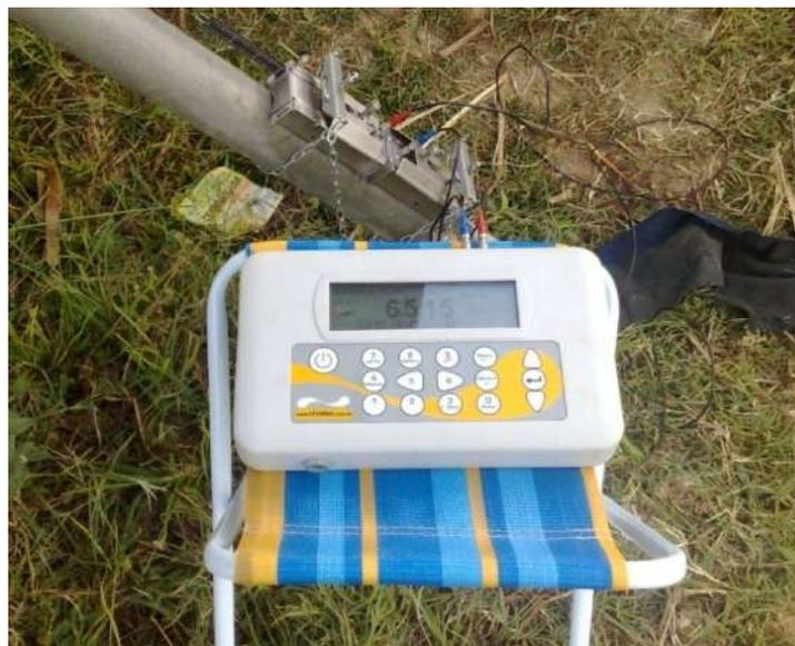
**Foto 4.12** Medidor de vazão ultrassônico.
