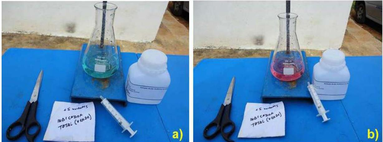
**Foto 5.2** Titulação *in situ* no PT-77, com utilização de indicador misto “verde de bromocresol” em alíquota apresentando pH 6,98 (a) e posteriormente com variação a coloração rosa, após aplicação de ácido sulfúrico ( $H_2SO_4$ ) na concentração de 0,1 N (b).
